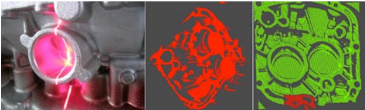
Bild 5: Oberflächenerfassung durch Lasertriangulation
