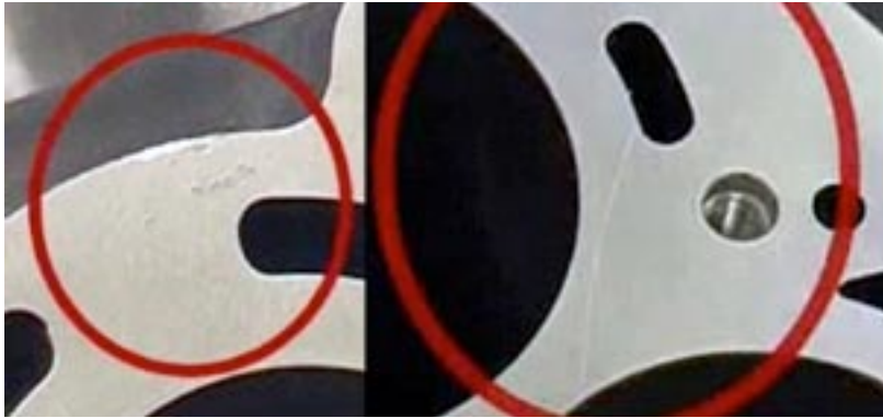
Bild 1: Oberflächenfehler an bearbeiteter Gussteilfläche
